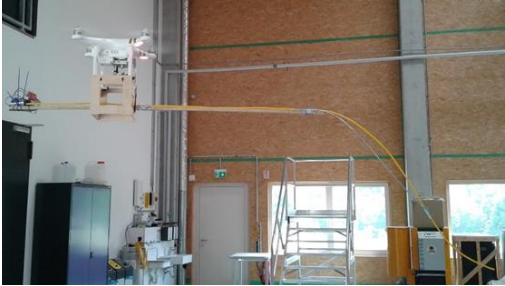
Abb. 14: Fliegender Prototyp einer kommerziell erhältlichen Drohne mit angebautem VOC-Sampling-System für die Beprobung des Kronenraumes
