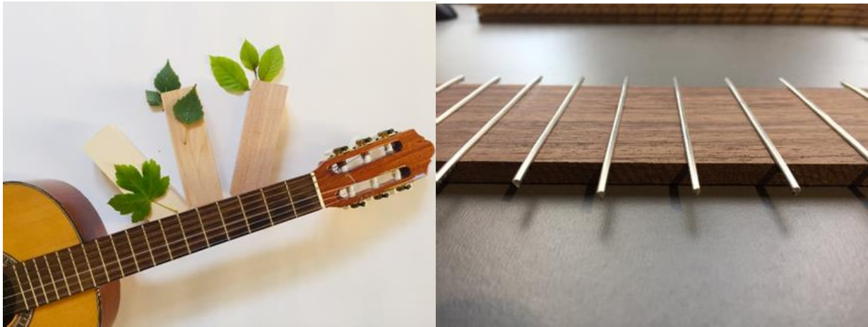
Abb. 9: Einsatz modifizierter heimischer Holzarten für Gitarrengriffbretter
